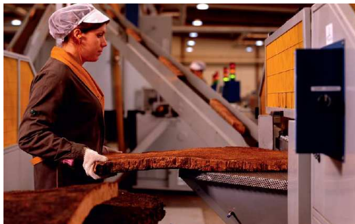
1.7. attēls. Korķa aizbāžņu izfrēzēšana no strēmēlēm.
