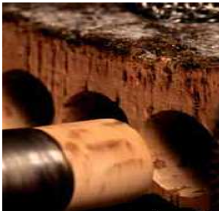
1.7. attēls. Korķa aizbāžņu izfrēzēšana no strēmēlēm.
